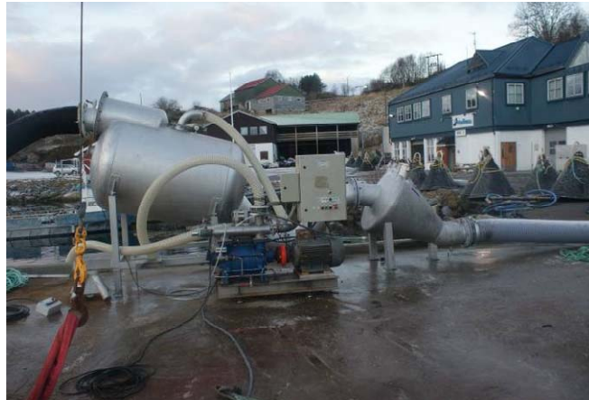
Figur 25 Pumpa brukt til Averøyforsøkene var av typen Stranda Prolog.
