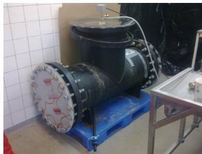
Figur 44 Vakuumtank for uttesting av vakuum på ubedøvd laks. Inngangen er øverst.
